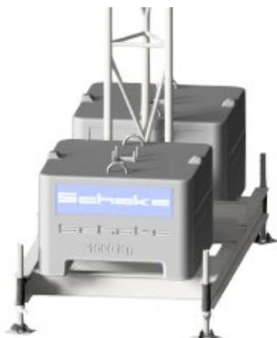
5. Gitterrohrmast mit Adapterplatte auf dem Aufstellrahmen verschrauben
